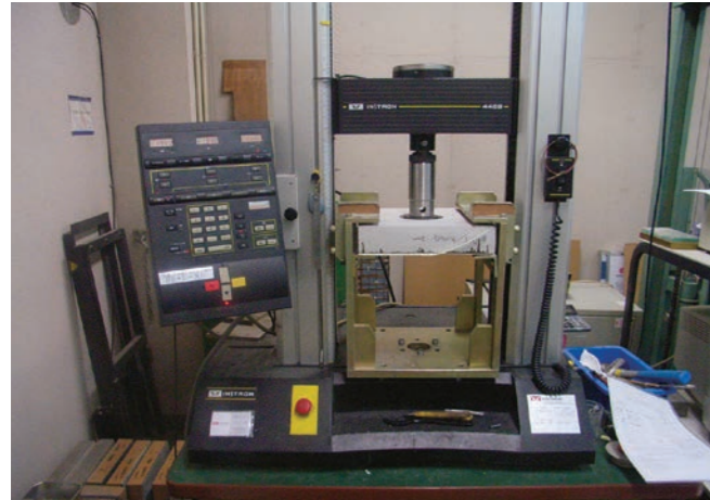
繊維非挿入で「A種 1.5kN、B種 0.3kN以上」を確保。
